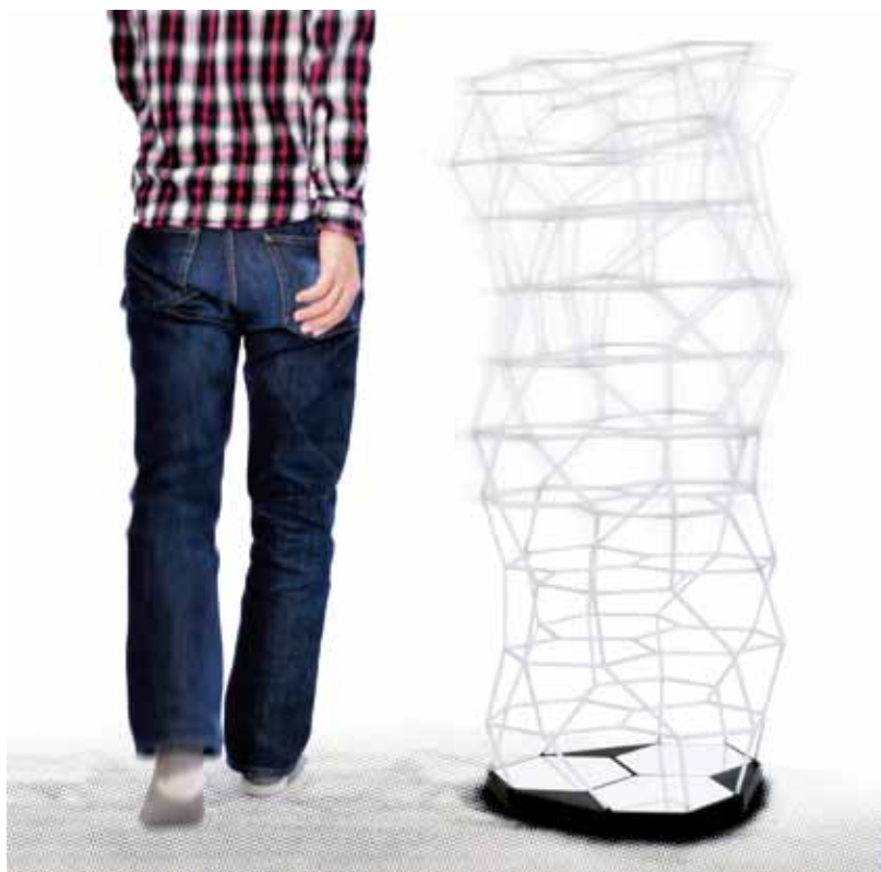
内蔵された赤外線センサにより周辺の人の動きを察知すると土台が震え、それに伴い全体が生き物のように動き出す。それぞれの関節にはLEDが埋め込まれており、動きに合わせて明滅する。
